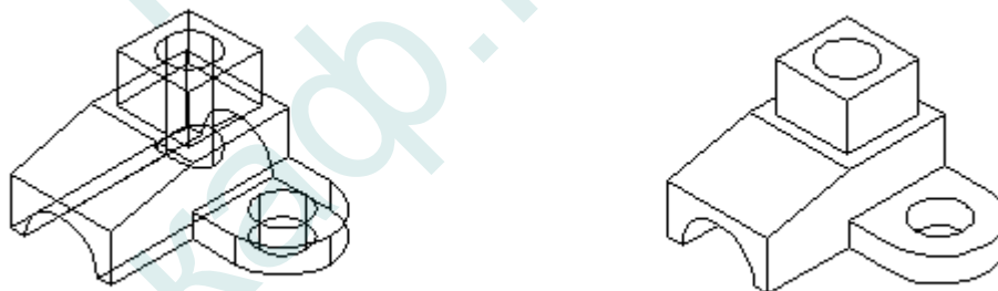
Рис.8.7 Вид модели до и после действия команды т-профиль с отключением соответствующих слоев
