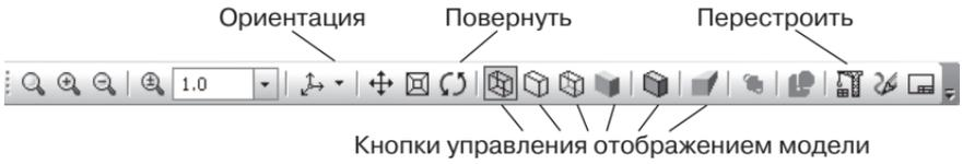
Рис. 112. Инструментальная панель Вид
