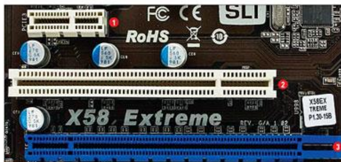
Наиболее популярные слоты расширения на материнских платах – PCI Express x1 1, PCI 2 и PCI Express X16 3
