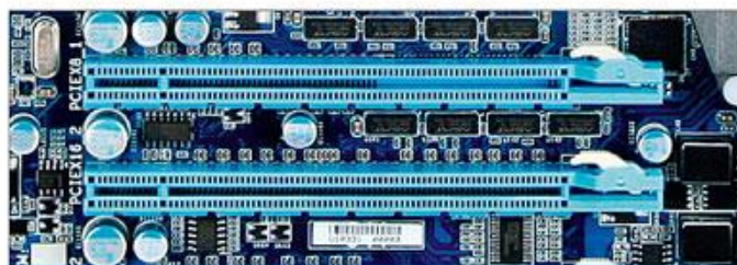
Самые длинные из слотов PCIe работают в режимах 16x и 8x, однако в зависимости от количества доступных сигнальных линий шины PCI Express их производительность может быть и ниже
