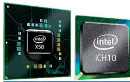
Чипсет Intel X58 Express содержит микросхему северного моста, но контроллер памяти находится в ЦП. Используемая шина – QPI
