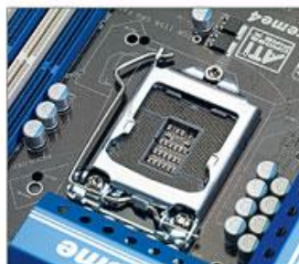
Процессорные сокет Intel LGA1156 и LGA775 похожи внешне, однако различаются размерами и абсолютно несовместимы друг с другом
