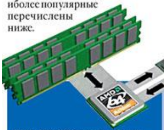
Шина HyperTransport работает с частотой 3,2 ГГц и передает до 51,2 Гб данных в секунду
