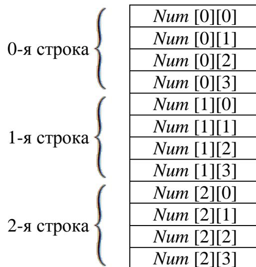
Рис.11.1. Размещение в памяти элементов двухмерного массива  $Num$  размерности 3x4.
