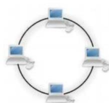
*"Кольцо"* -эта топология представляет собой последовательное соединение компьютеров, когда последний соединён с первым. Сигнал от компьютера к компьютеру в одном направлении. Каждый как повторитель, усиливая сигнал и передавая его дальше. проходит через каждый компьютер, сбой одного из них приводит к нарушению работы всей сети.
