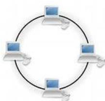
*"Кольцо"* -эта топология представляет собой последовательное компьютеров, когда последний соединён с первым. Сигнал от компьютера к компьютеру в одном направлении. Каждый как повторитель, усиливая сигнал и передавая его дальше. Проходит через каждый компьютер, сбой одного из них нарушению работы всей сети.
