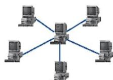
*Топология "Звезда"* схема соединения, при которой каждый компьютер подсоединяется к сети при помощи отдельного соединительного кабеля. Один конец кабеля соединяется с гнездом сетевого адаптера, другой подсоединяется к центральному устройству, называемому концентратором (hub).
