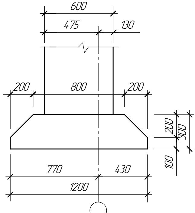
ПРИВЯЗКА ФУНДАМЕНТНЫХ ПЛИТ ПОД САМОНЕСУЩИЕ НАРУЖНЫЕ СТЕНЫ
