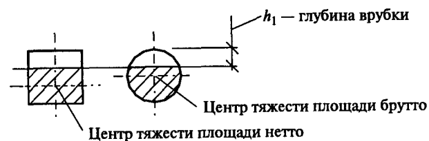
Рис. 9.16. Положение осей в узле деревянной фермы
