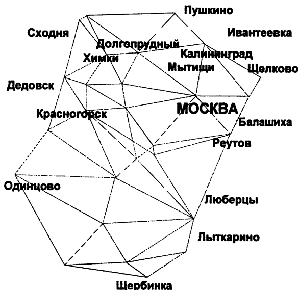
Рис. 8.2. Схема геодинамической сети Москвы
