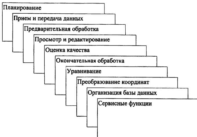
Рис. 6.4. Общая структура программы обработки фирмы-изготовителя спутниковых приемников
