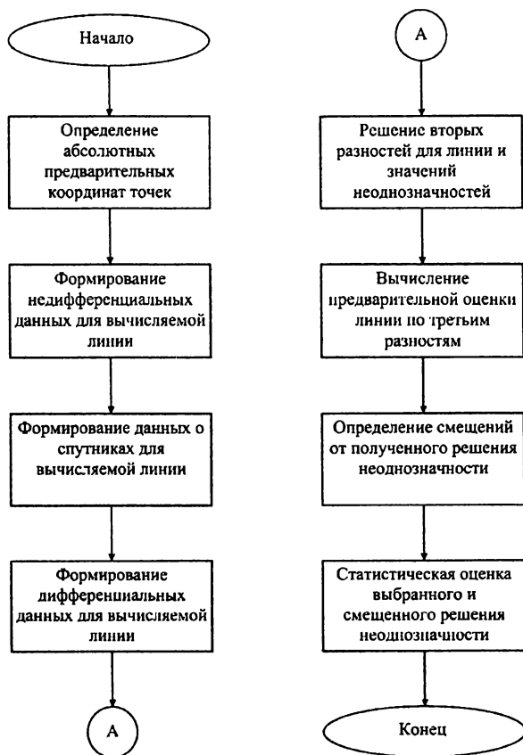
Рис. 6.1. Общий алгоритм вычисления отдельной линии
