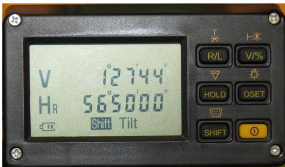
Рисунок 2 – Внешний вид панели управления электронного теодолита VEGA ТЕО-5В
