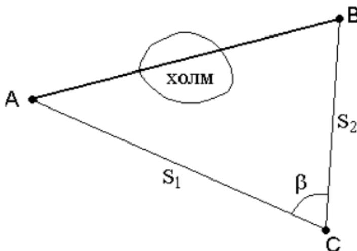
Рисунок 2 - Косвенное измерение расстояния через холм
