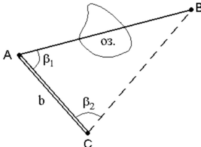
Рисунок 1 - Косвенное измерение расстояния через озеро
