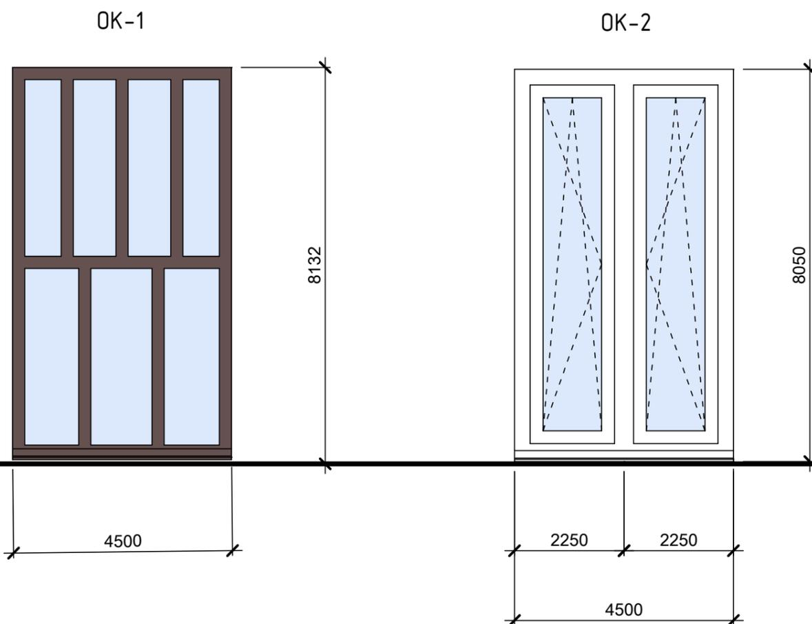
Схема заполнения дверных проемов
