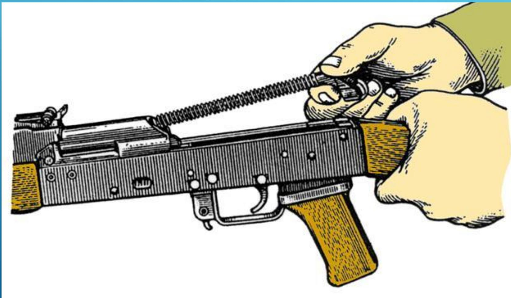
**Отделить затворную раму с затвором.** Продолжая удерживать автомат левой рукой, правой отвести затворную раму назад до отказа, приподнять ее вместе с затвором и отделить от ствольной коробки.
