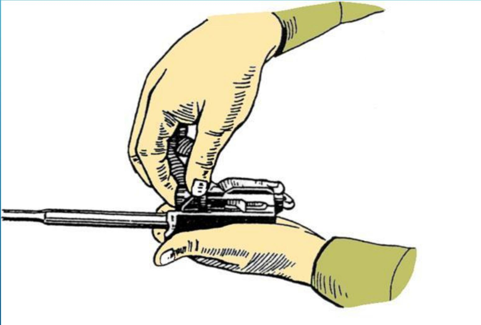
**Отделить газовую трубку со ствольной накладкой.** Удерживая автомат левой рукой, правой надеть пенал принадлежности прямоугольным отверстием на выступ замыкателя газовой трубки, повернуть замыкатель от себя до вертикального положения и снять газовую трубку с патрубка газовой камеры.
