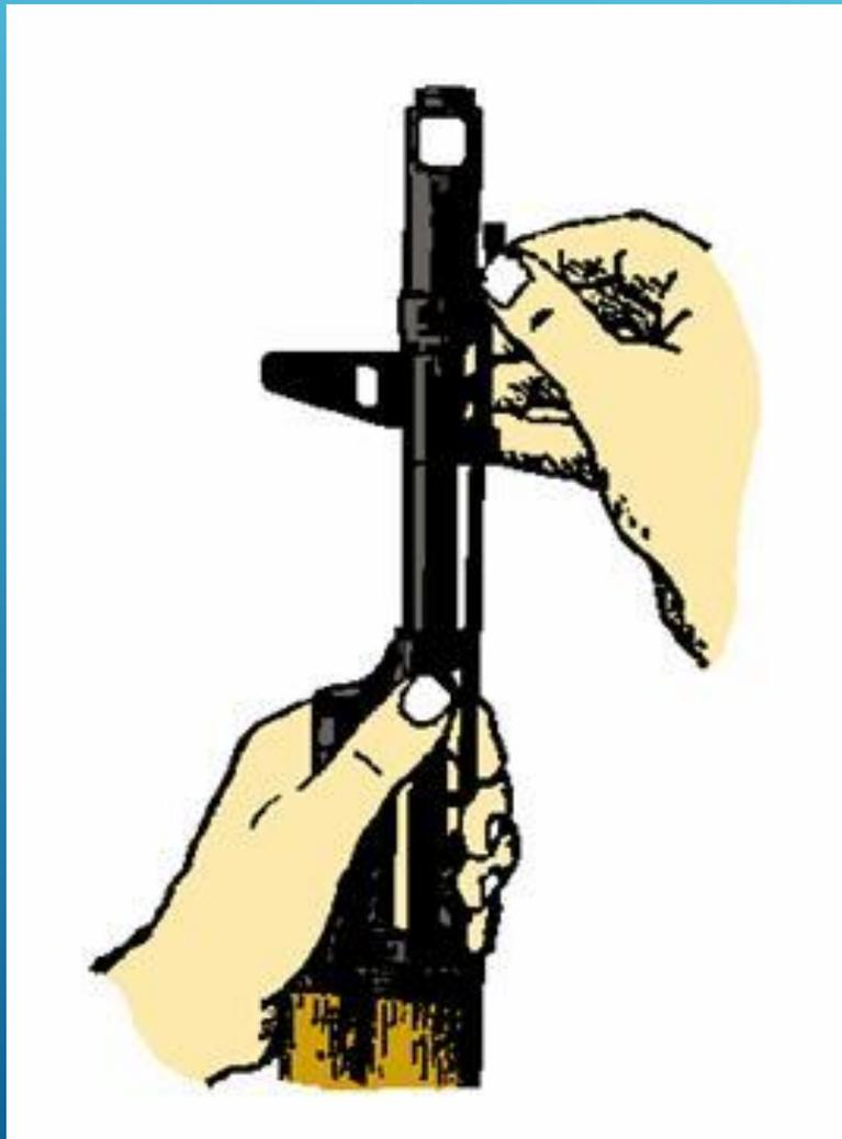
**Отделить крышку ствольной коробки.**левой рукой обхватить шейку приклада, большим пальцем этой руки нажать на выступ направляющего стержня возвратного механизма, правой рукой приподнять вверх заднюю часть крышки ствольной коробки и отделить крышку.
