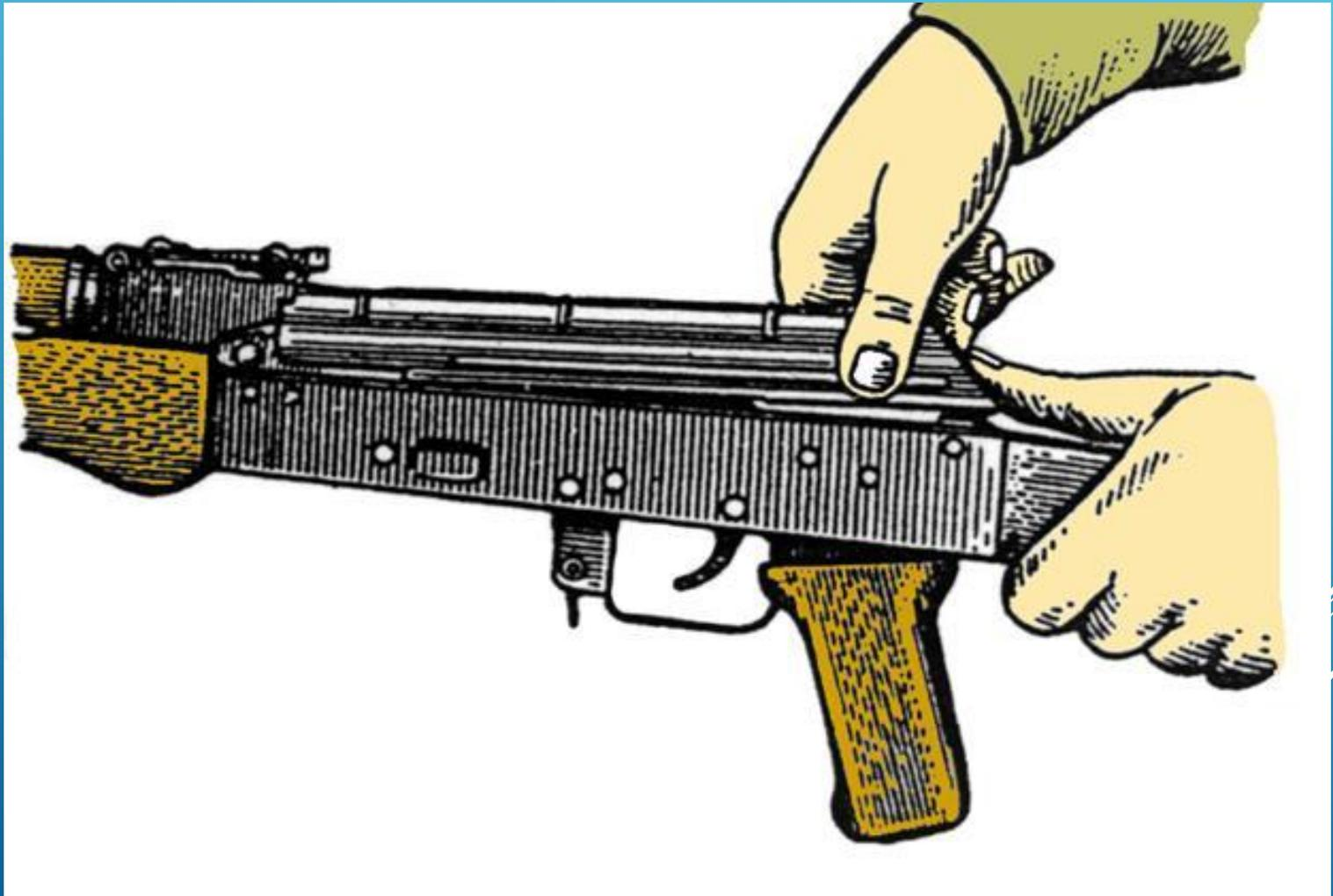
**Отделить возвратный механизм.** Удерживая автомат левой рукой за шейку приклада, правой рукой подать вперед направляющий стержень возвратного механизма до выхода его пятки из продольного паза ствольной коробки; приподнять задний конец направляющего стержня и извлечь возвратный механизм из канала затворной рамы.
