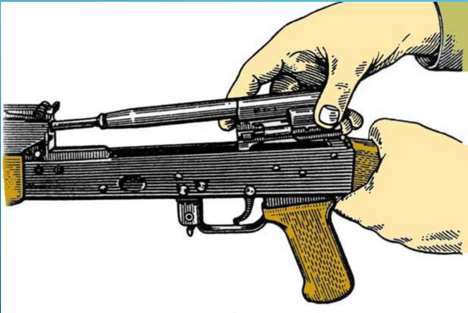
**Отделить затвор от затворной рамы.** Взять затворную раму в левую руку затвором кверху правой рукой отвести затвор назад, повернуть его так, чтобы ведущий выступ затвора вышел из фигурного выреза затворной рамы, и вывести затвор вперед.
