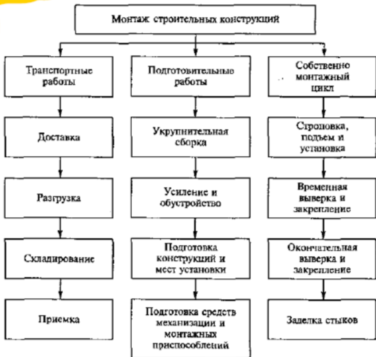
Рис. 11.2. Схема технологического процесса монтажа строительных конструкций
