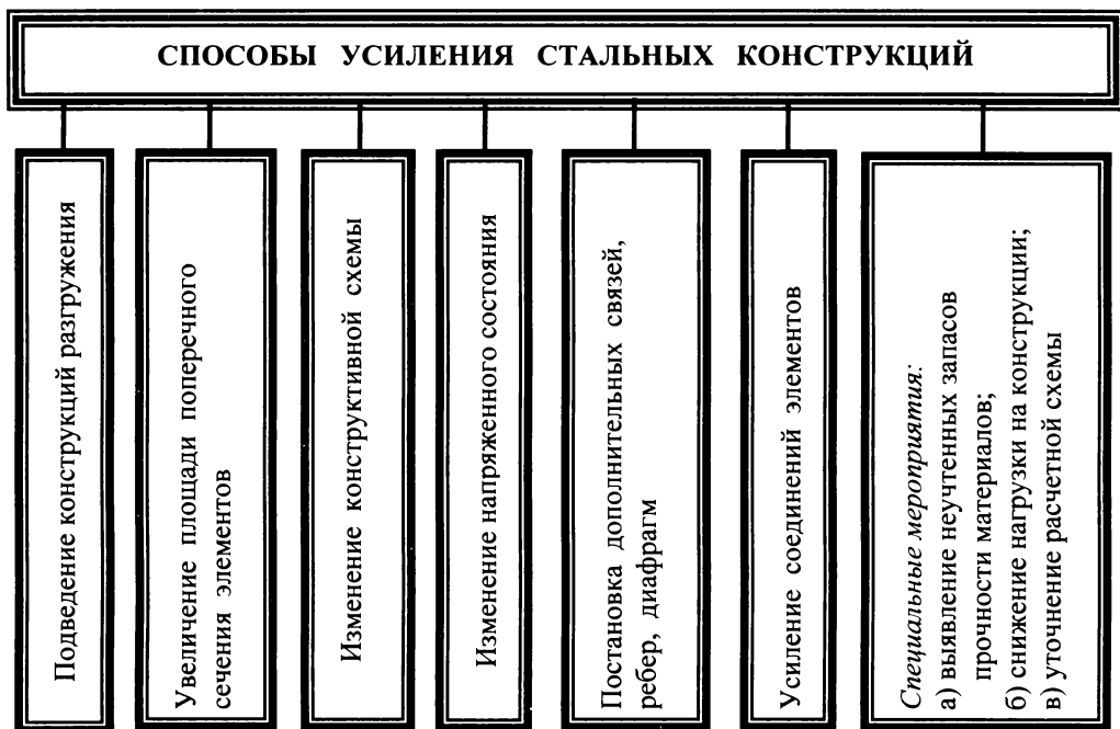
Рис. 3.1. Классификация способов усиления стальных конструкций
