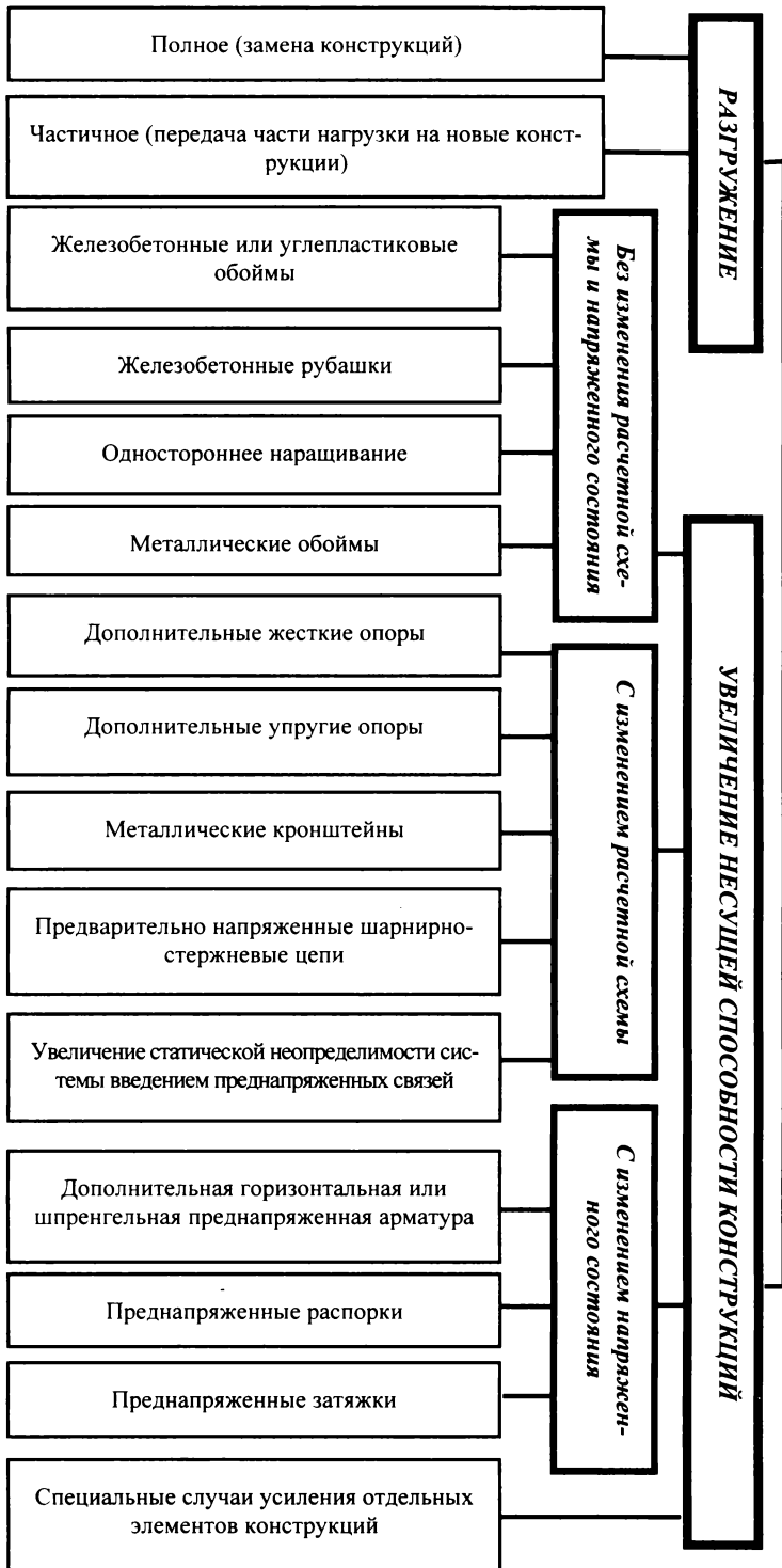
Рис. 5.1. Классификация основных способов усиления железобетонных конструкций
