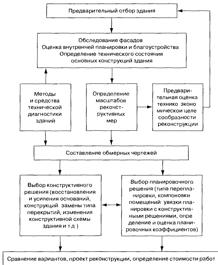
Рис. 3.2.1. Последовательность проектирования реконструкции здания
