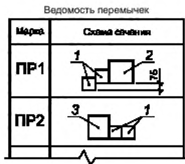
Рисунок В.1 — Пример выполнения ведомости перемычек
