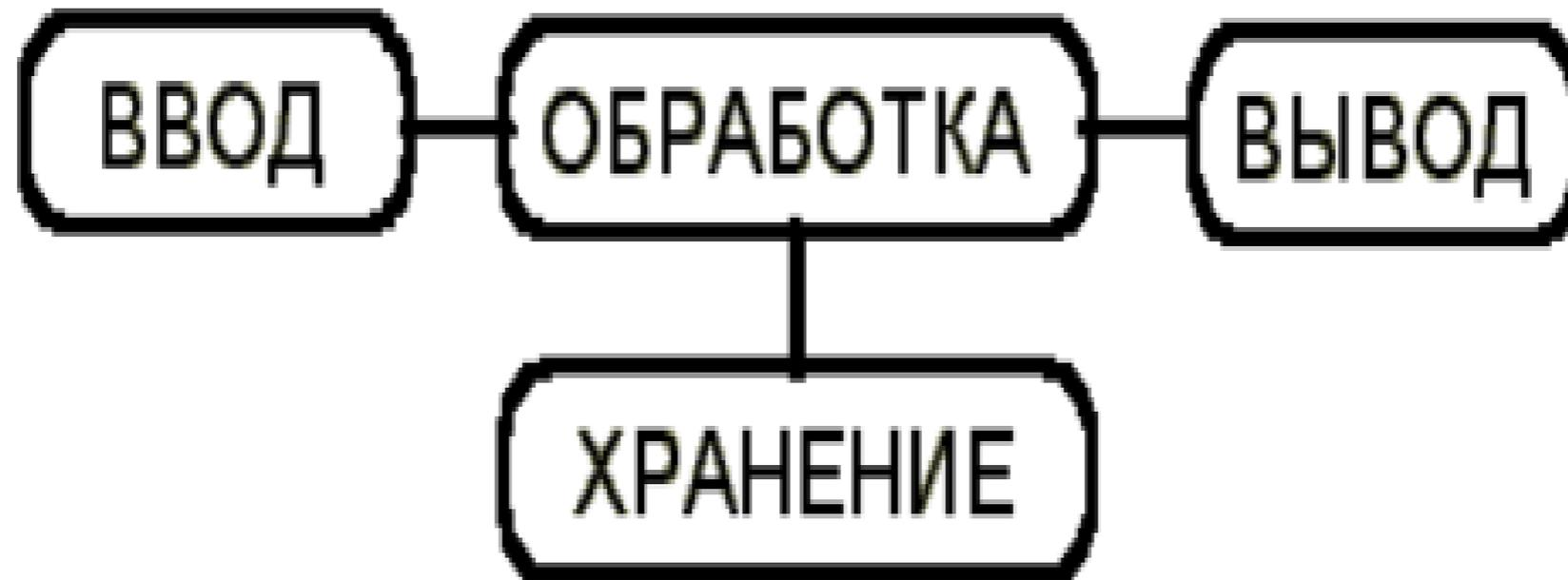
Рисунок 10 – Схема действий, выполняемые компьютером
