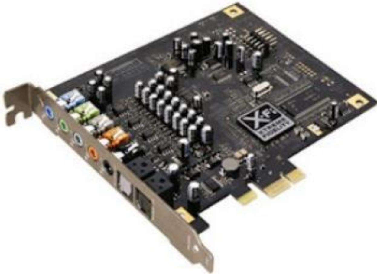
**Аудиоадаптер** - специальная электронная плата, которая позволяет записывать звук, воспроизводить его и создавать программными средствами с помощью микрофона, наушников, динамиков, встроенного синтезатора и другого возможного оборудования
