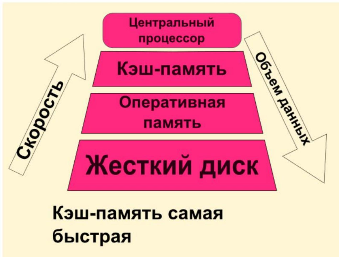
**Кэш – память** - это очень быстрое запоминающее устройство небольшого объема, которое используется при обмене данными между микропроцессором и оперативной памятью для компенсации разницы в скорости обработки информации процессором и несколько менее быстродействующей оперативной памятью
