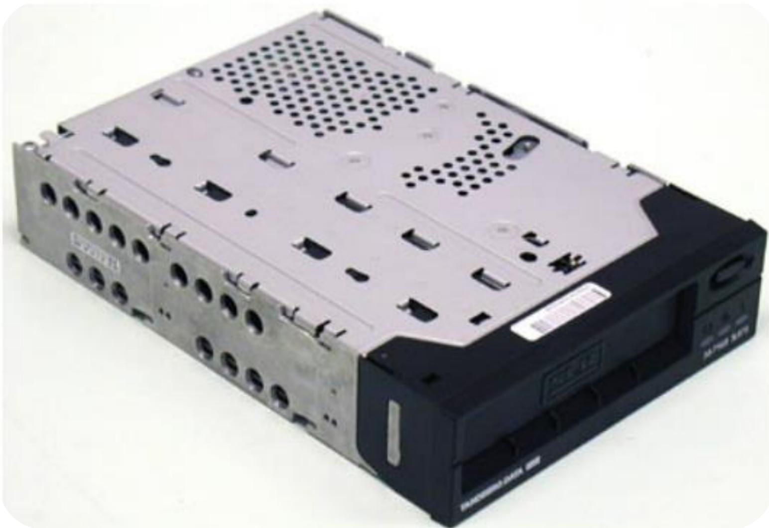
**Стример** - устройство для резервного копирования больших объемов информации. В качестве носителя здесь применяются кассеты с магнитной лентой ёмкостью 1 - 2 Гбайта и больше
