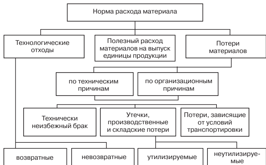
Рис. 10.21. Состав нормы расхода материалов на производство единицы продукции
