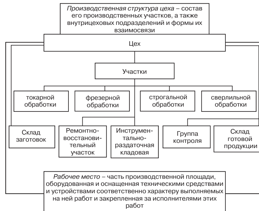
Рис. 8.7. Характеристика производственной структуры цеха и рабочего места
