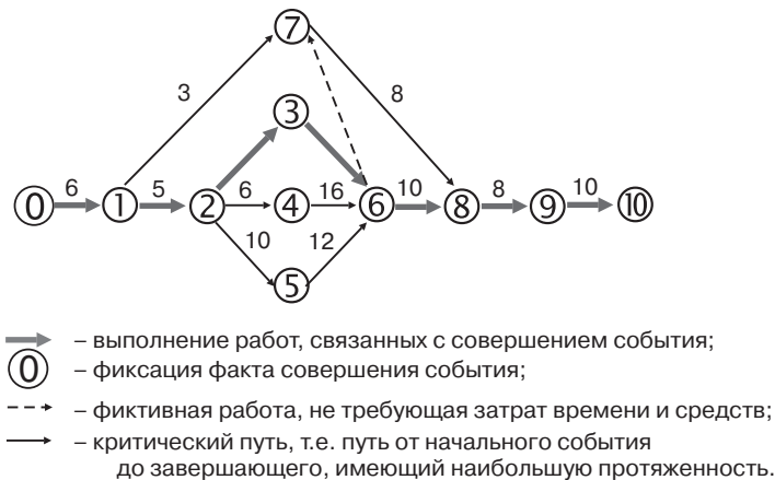
Рис. 9.30. Схема сетевого планирования и управления технической подготовкой производства
