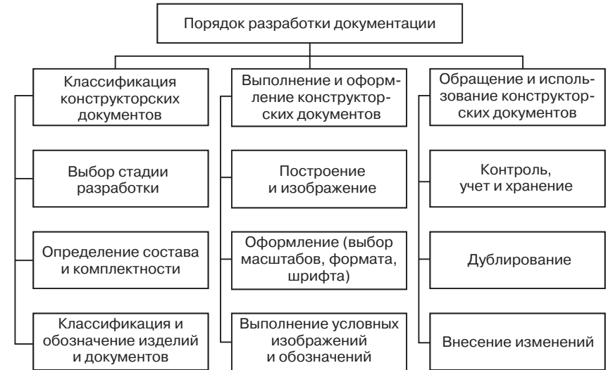
Рис. 9.12. Порядок разработки конструкторской документации на основе ЕСКД
