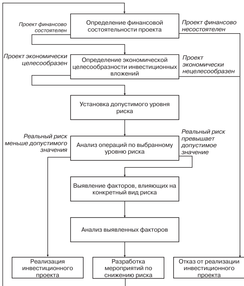
Рис. 23.10. Блок-схема анализа риска при реализации инвестиционного проекта
