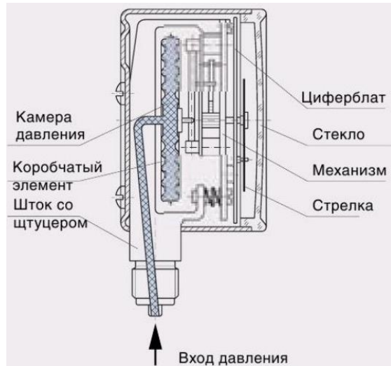
Рис. 3. Схема манометра с коробчатой пружиной
