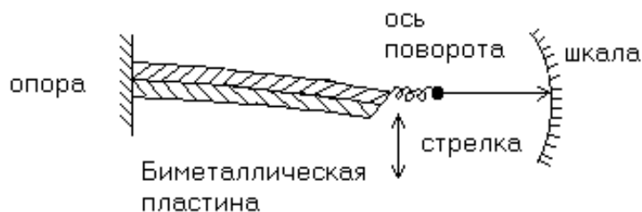
Рис. 1. Схема биметаллического термометра
